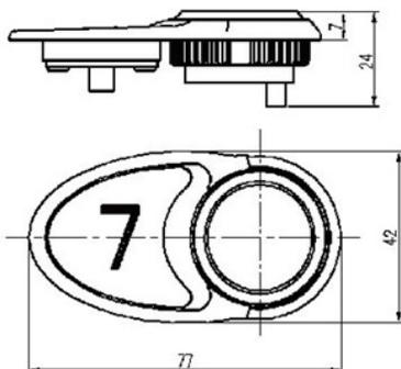
Le Bouton AD-200 est un modèle très versatile, durable et magnifique. Il peut être utilisé en double illumination, c'est-à-dire que le chiffre reste illuminé en permanence et le contour du bouton s'allume pour enregistrer l'appel. Le bouton est garanti 1 an, mais il a une durée de vie de plus de cinq millions d'appels.
